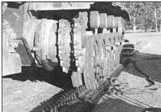
Det nya och det gamla bandet ligger på backen och nu ska drivhjulet bytas på stridsvagn 101R.
