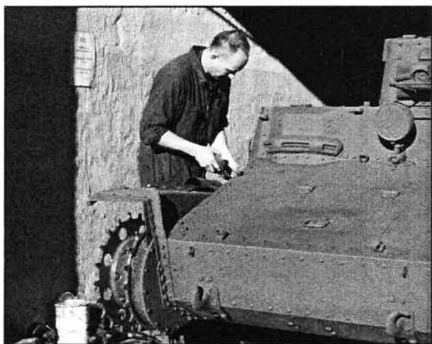
Här slipas det mellan de olika målningsvarven.
