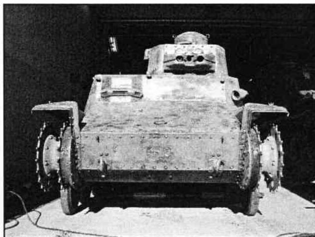
En avskalad strv 37 där till och med färgen har åkt av.
